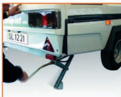
Die 2 hinteren Kurbelstützen mit der Handkurbel hinunterdrehen. Der Anhänger sollte waagrecht ausgerichtet werden. Die 2 Räder sollten leicht den Boden berühren.
